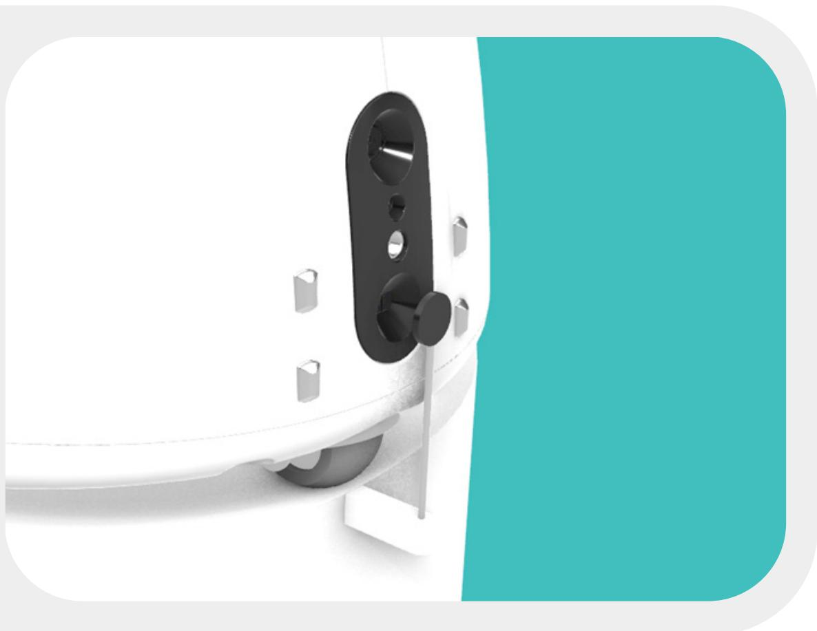
*Cible d'orientation du robot détectée par le TOF Long Range à l'arrière de Buddy*
